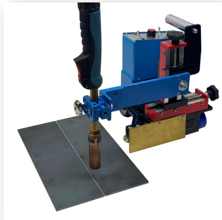
КС-4 сварка угловых и стыковых швов
