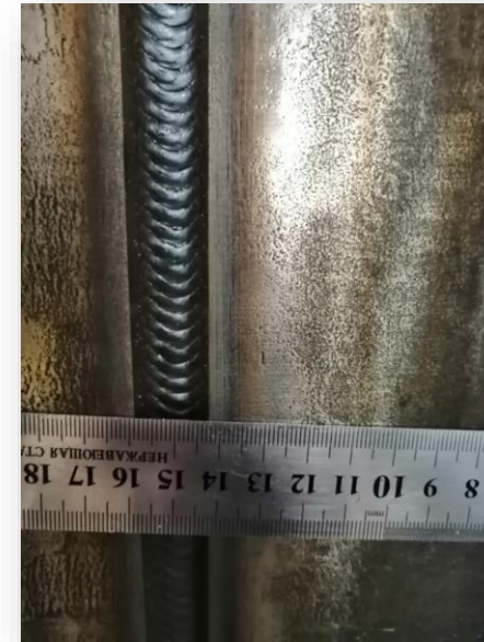
Корневой и облицовочный проходы (толщина 32 и 22 мм, Х-образная разделка)
