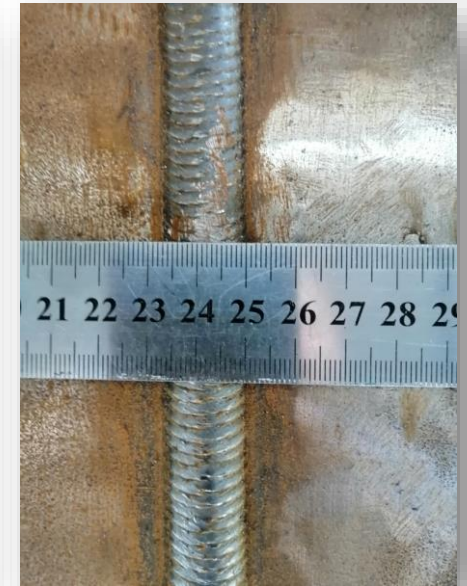
Корневой и облицовочный проходы (толщина 32 и 22 мм, Х-образная разделка)
